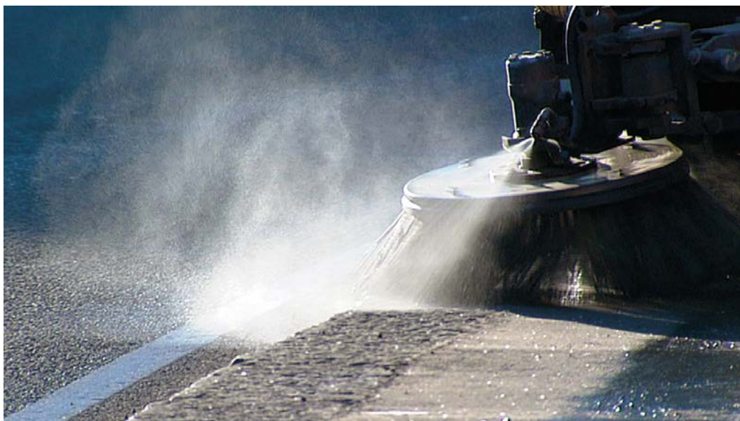
Rengjøring av veien gjennom Kannik i Stavanger. Flere kommuner har gjennomført drifts- og vedlikeholdstiltak på vei for å redusere konsentrasjonsnivåene av svevestøv.
