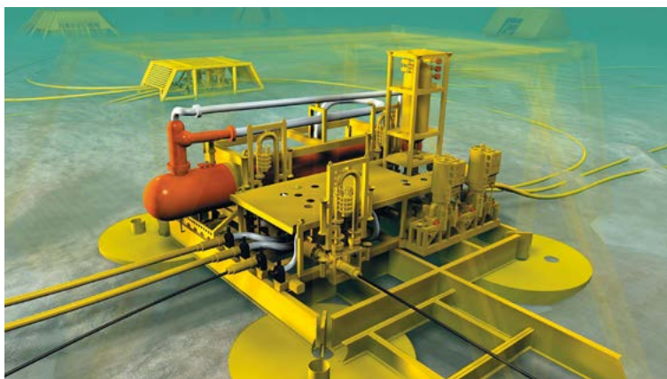
DEMO 2000 støttet testing av undervannsseparasjon og -reinjeksjon av vann fra reservoaret som produseres sammen med olje ved Tordis-feltet.
